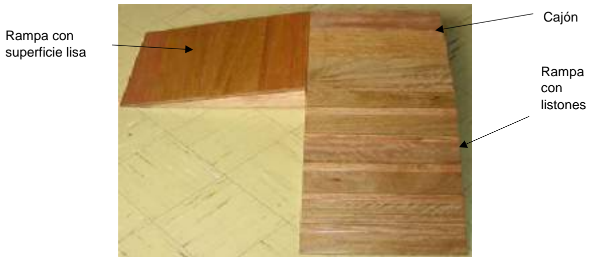
Figura 2 Rampa con listones
